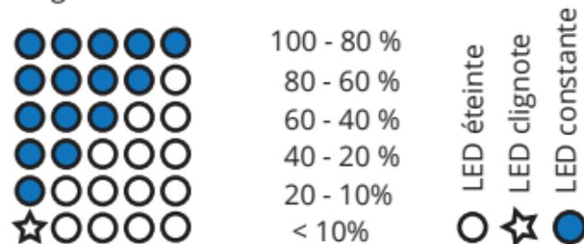
Si une seule LED clignote, le notstrøm dispose de moins de 10 % de ses capacités et doit être rechargé.
